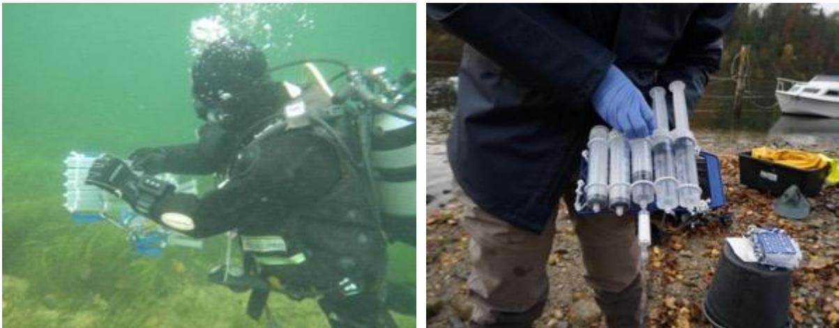
Abb. 4.3: eDNA Probenahme im Rahmen der koordinierten biologischen Untersuchungen am Hochrhein 2017. Die Methode wurde hier erstmals im Unterwassereinsatz getestet. Links: Aufziehen der 50 ml-Spritzen unter Wasser. Rechts: Mikrofiltration der UW-Proben an Land. Foto: Hydra.
